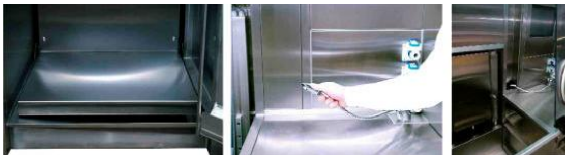
Ilustração 2: Bandeja coletora na posição de instalação com uma coluna de elevação integrada de fácil limpeza.
